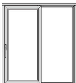
HST Meridiana Zero è realizzabile nelle aperture **Schema A Sinistro** e **Schema A Destro**.
